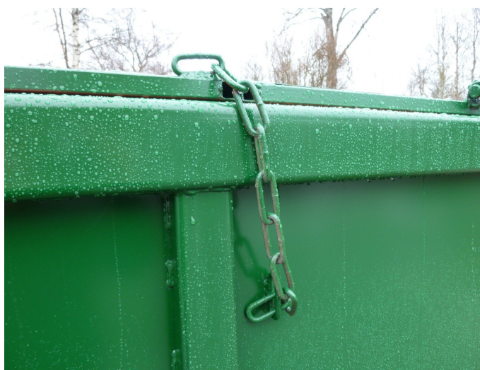
Bild 7: Tömningslucka låses med hänglås, på motsvarande sida finns ett järn som gör att lucka inte kan öppnas.
